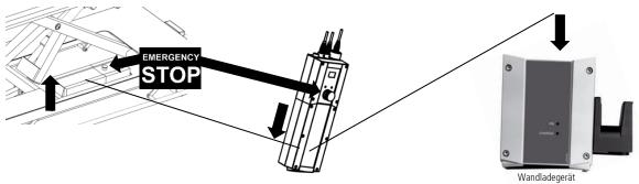
Beachten Sie, dass mit einem vollständig geladenen Akku ca. 30 Zyklen (ein Zyklus = mit 100 kg beladen von ganz unten bis ganz nach oben, und wieder bis ganz nach unten) möglich sind. Die Dauer für eine Komplettladung beträgt ca. 6 Stunden. Den Ladezustand der Batterie erkennen Sie in Prozent auf dem Display auf der Controllbox.
